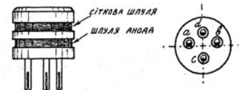
Мал. 1 і 2. Розміщення шпуль на сокелі: а—початок сіткової шпулі (до—і), б—кінець сіткової шпулі (до сітки), с—початок анодної шпулі (до аноду), д—кінець анодної шпулі (до—А).
