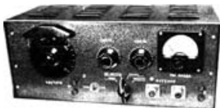
Передатчик начинающего ультракоротковолновика (UA1FA-UA1AB – трансивер «ДЛ-68»), 1968 г.
