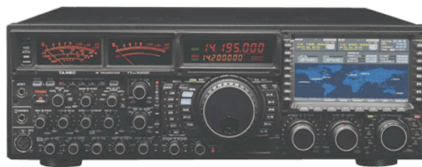
КВ трансивер FT-DX9000
