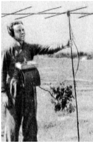
К. Фехтел (UB5WN) – облегченная 4-элементная антенна и приемник 1-V-1 на двух сетевых пальчиковых лампах и одном кристаллическом триоде П1Е
